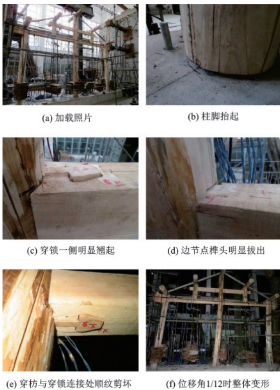
图7 试件CF试验现象
